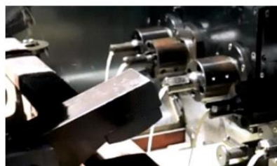
сверление отверстий с применением СОЖ
