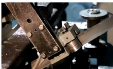
разрезка рельса ленточной пилой
