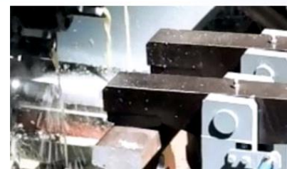
вертикальный зажим рельса при обработке
